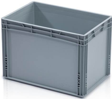
Der Eurobehälter ist ein vielseitiger Helfer in allen Industriezweigen. Er ist hygienisch, einfach stapelbar und somit für Transport und Lagerung geeignet. Beständig gegen Kälte und Kontaktwärme, Säuren und Laugen. Kunststoffbehälter aus hochwertigem Polypropylen. Optimierte für den Einsatz in der automatisierten Logistik (geeignet für den Einsatz auf Förderbändern und Rollenbahnen). Möglichkeit der Bedruckung.
