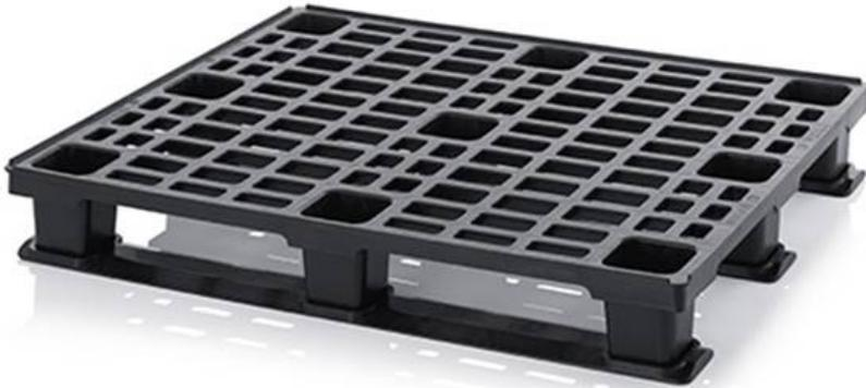
Die ESD-Paletten aus elektrisch leitfähigem Kunststoff wurden speziell für die sichere Lagerung und den Transport von empfindlichen elektrischen Bauteilen entwickelt. Sie verhindern zuverlässig die elektrostatische Entladung und leiten die vorhandene Entladung ab. Spez. Strömungswiderstand/Oberflächenwiderstand  $10^4 < 10^{10}$  Ohm.
