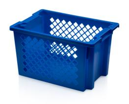
Die Stapelbehälter sind für Lebensmittel, Lagerung und Transport geeignet. Sie sind für den Kontakt mit Lebensmitteln zugelassen. Die Behälter sind stapelbar. Mit einer einfachen Drehung lassen sich die leeren Behälter ineinander schieben, wodurch viel Platz gespart wird, was in der Logistik einen großen Vorteil darstellt. Perforierte Behälter, geschlossene Griffe, glatter Boden - Luftzirkulation ist eine Selbstverständlichkeit.
