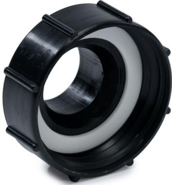
IBC-Reduzierstück (Adapter) DN 80 – Innengewinde S 100 x 8 (grob)/DN 50 Außengewinde S 60 x 6 (grob).
